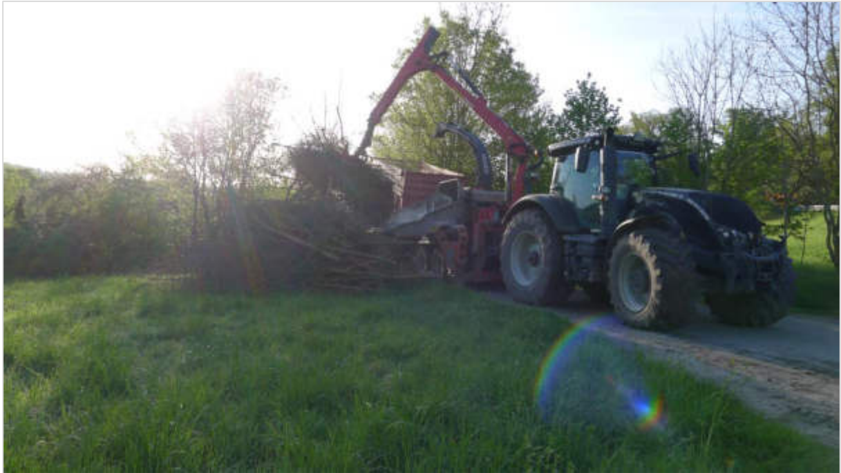
Abb. 16: Schnittgut wird gehackt und das Hackgut direkt in einen Muldenkipper eingeblasen.
